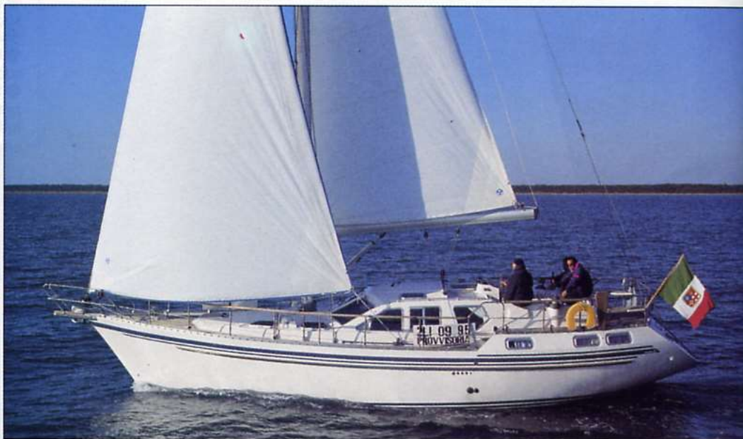
Il Nauticat 42 è un motorsailer a displacement pesante, caratterizzato da entrate di prua molto stellate e sezioni piene fino a estrema poppa e da un moderato sviluppo della superficie velica.
