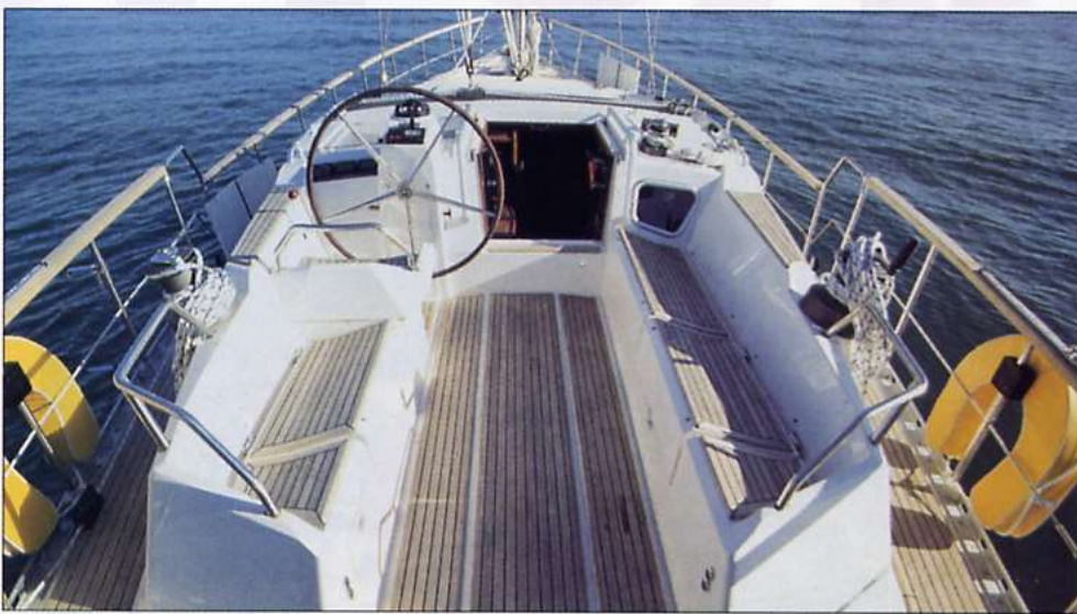
Il pozzetto è formato da due panche asimmetriche, molto alte rispetto al piano del ponte. Per agevolare l'agilità, la timoneria è posta su un lato della tuga.
