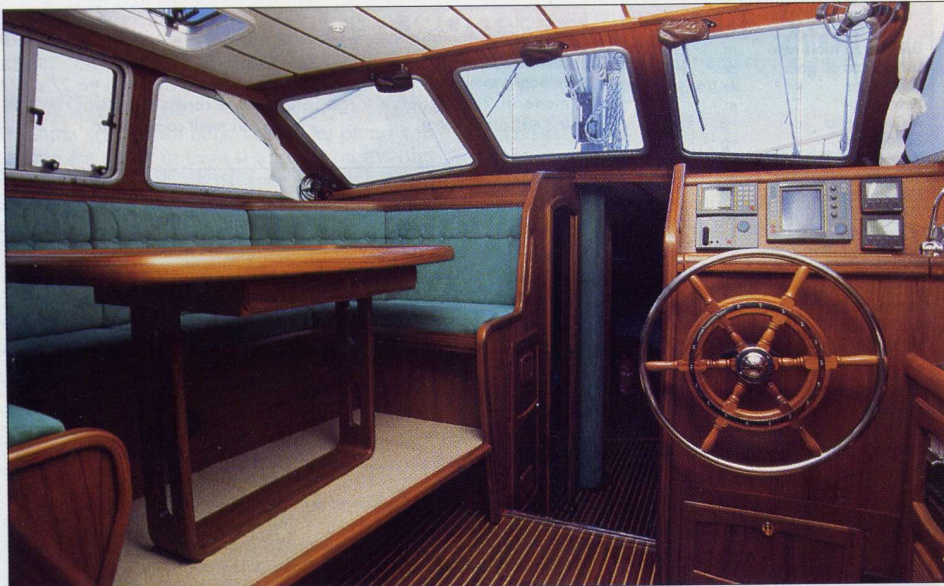
Nella deck house sopraelevata è posta la timoneria al coperto, con strumentazione frontale e il lungo tavolo di carteggio a lato. Il circuito idraulico della ruota può essere escluso.
